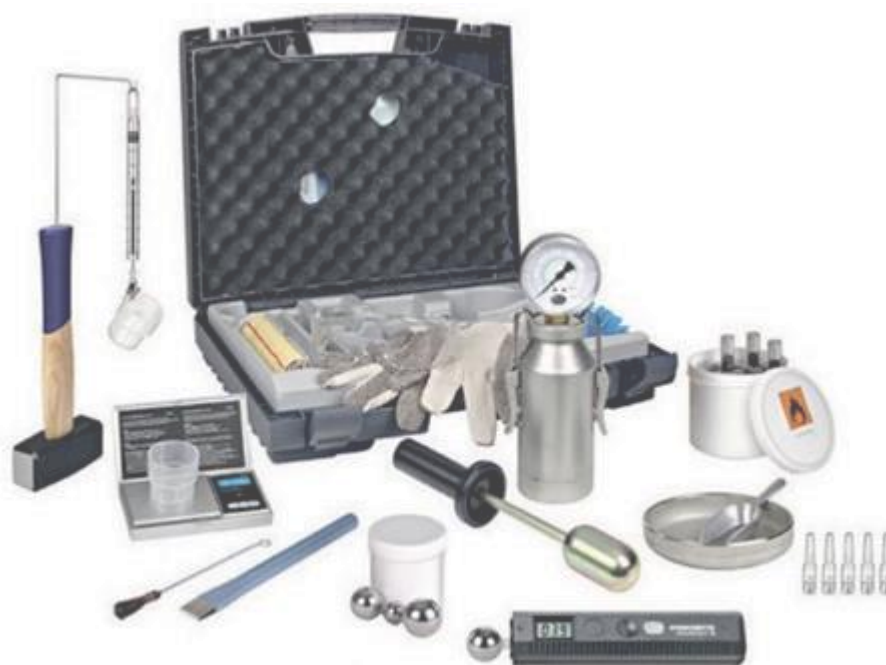
FIG. 1 - KIT PER LA MISURAZIONE DELL'UMIDITÀ RESIDUA DEI MASSETTI (Immagine di HYDROMAT CM-P PRO)
